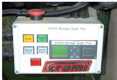
T trattore John Deere modificato con sistema a due serbatoi. Sopra, la centralina elettronica (Bioka) che controlla in continuo l'alimentazione olio vegetale/gasolio (Sistema Landtechnik GRAML).
