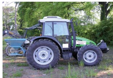
T trattore Deutz Fahr modificato con sistema a un serbatoio (VWP). Il trattore è della Provincia di Firenze e rientra in un progetto sperimentale condotto dal CREAR ( www.de.unifi.it ).
