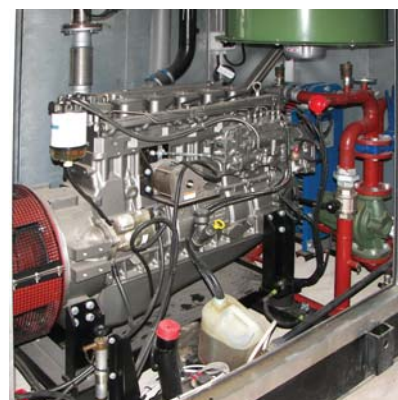
T trattore Deutz Fahr modificato con sistema a un serbatoio (VWP). Il trattore è della Provincia di Firenze e rientra in un progetto sperimentale condotto dal CREAR ( www.de.unifi.it ).
