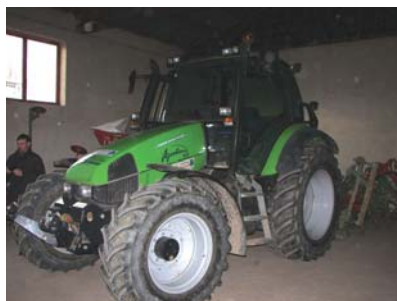
Il trattore Deutz Fahr modificato secondo il sistema Elsbett a due serbatoi.
