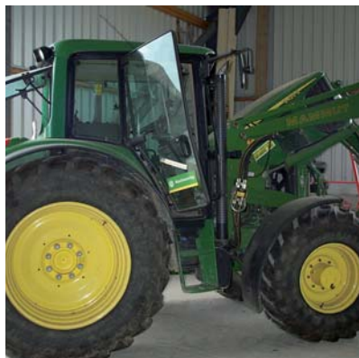
T trattore John Deere modificato con sistema a due serbatoi. Sopra, la centralina elettronica (Bioka) che controlla in continuo l'alimentazione olio vegetale/gasolio (Sistema Landtechnik GRAML).
